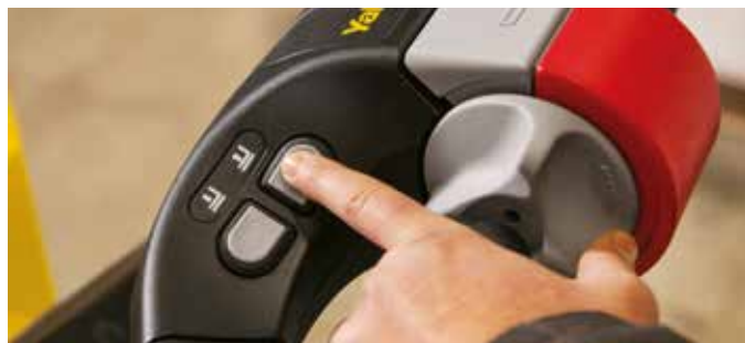
Технология управления подъемом Yale Smart Lift™ позволяет сокращать продолжительности циклов.
