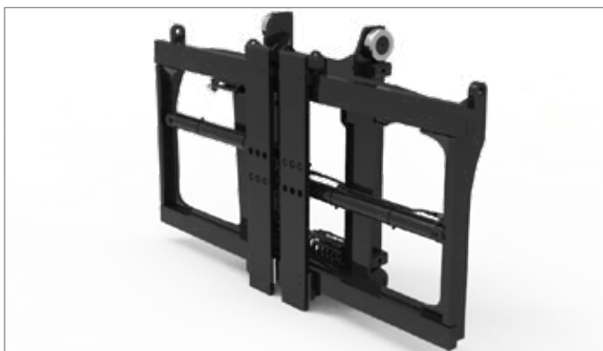
Быстросъемная двухфункциональная каретка навесного типа с боковым сдвигом, с синхронным и независимым позиционированием вил.
