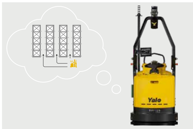
Fase 3 - La mappa di riferimento è caricata nella centralina del carrello robotizzato.
