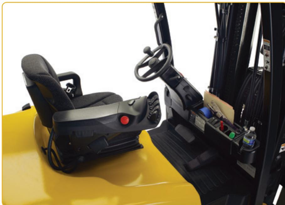
l'application s'avère plus ardue et exige des vitesses de pointe et d'accélération plus importantes pour atteindre une productivité plus élevée, il est possible d'activer un mode de fonctionnement HiP (hautes performances) via l'afficheur tableau de bord, grâce à un mot de passe "maintenance".
