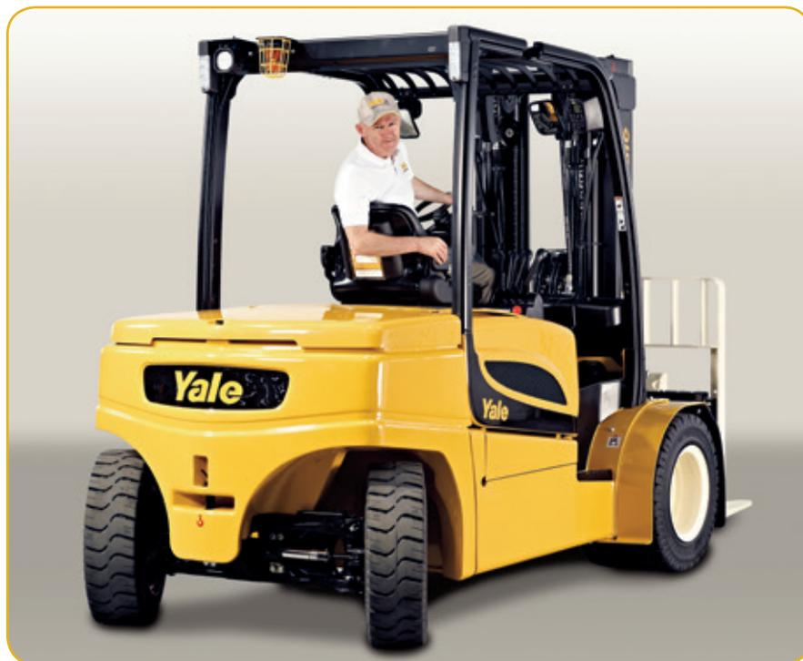
la productividad, incluyen; minipalancas AccuTouch™ integradas en el reposabrazos, kits de luces, tablero con desplazador lateral integrado, cabinas totales o parciales incluyendo calefacción opcional, recordatorio de mantenimiento programable opcional.
