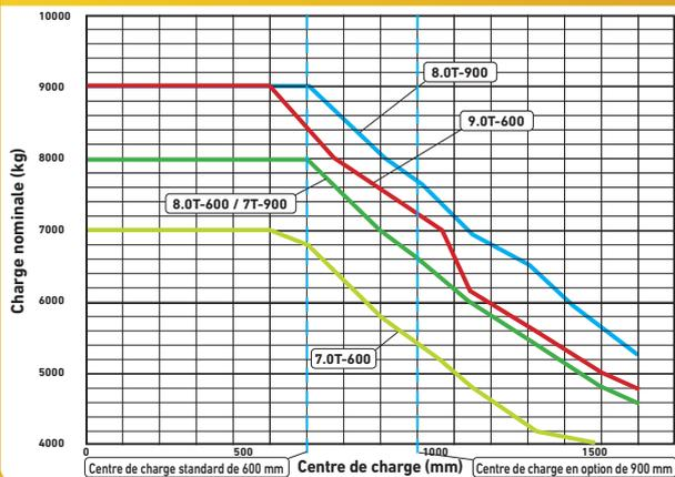
**Les cotes sont calculées en utilisant des fourches à haute résistance, 65x200mm au-dessus des centres de charge suivants pour atteindre la pleine capacité des chariots.**
