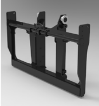
Standaard vorkpositionering Pentype vorkenbord.
