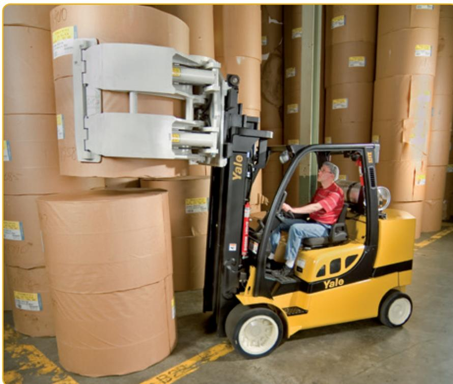
Un pedale unico che controlla sia l'avanzamento progressivo sia la frenatura. Un sistema di filtraggio a 100 maglie sulla linea di aspirazione e a 10 micron sulla linea di ritorno protegge la trasmissione dai contaminanti abrasivi.
