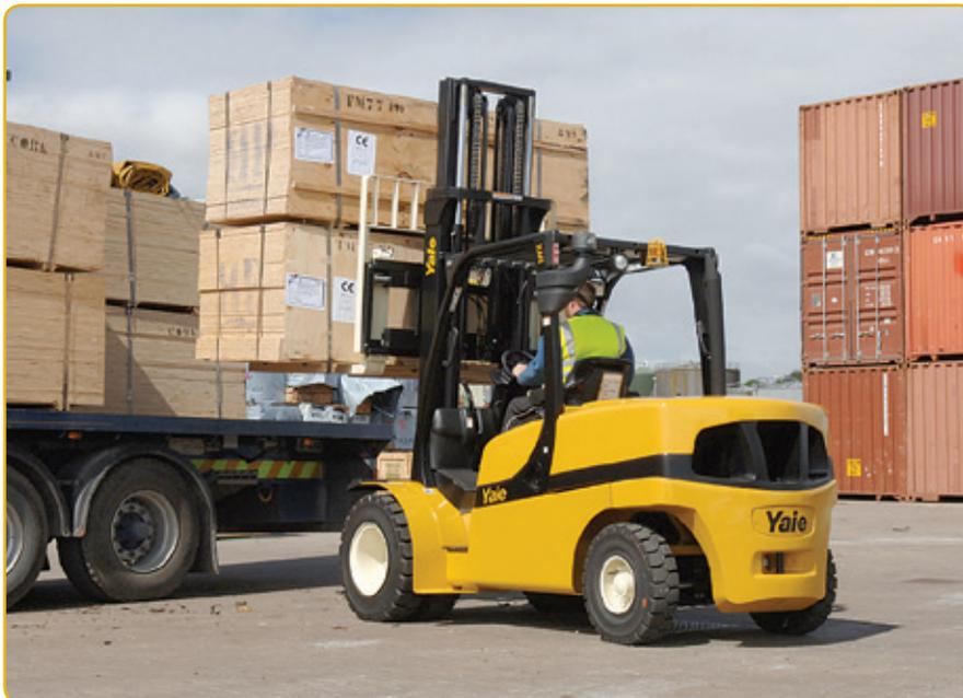
totale, allié à la chaîne cinématique isolée, offre les meilleurs niveaux de vibrations transmises à l'ensemble du corps du marché, à 0,6m/s<sup>2</sup>. Résultat : le confort de l'opérateur est maintenu pendant tout le cycle de travail et les vibrations ressenties sont réduites au minimum. La disposition des
