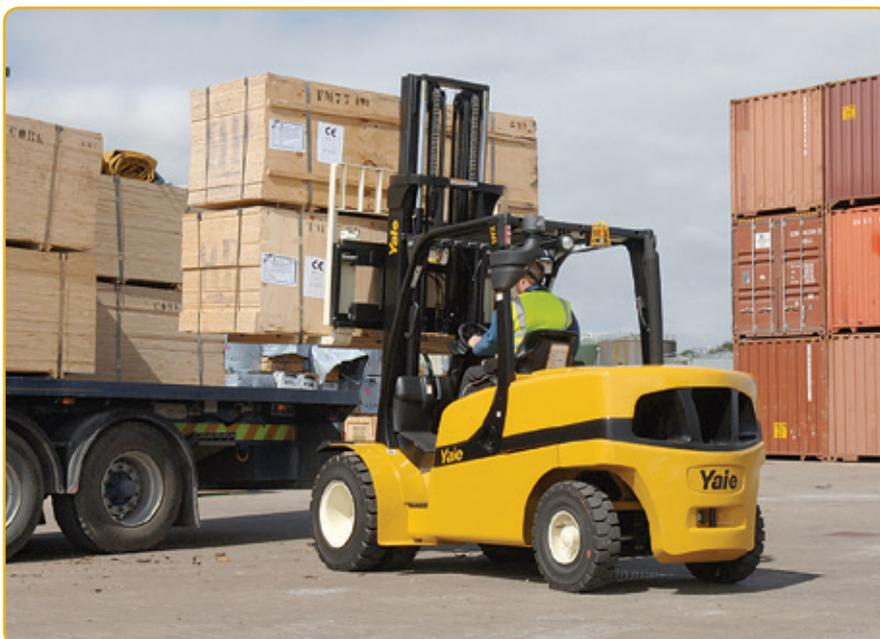
ainsi toutes les fonctions clés du chariot à portée de main. Le siège à suspension totale, allié à la chaîne cinématique isolée, offre les meilleurs niveaux de vibrations transmises à l'ensemble du corps du marché, à 0,6m/s<sup>2</sup>. Résultat : le confort de l'opérateur est maintenu pendant tout le cycle de travail et les
