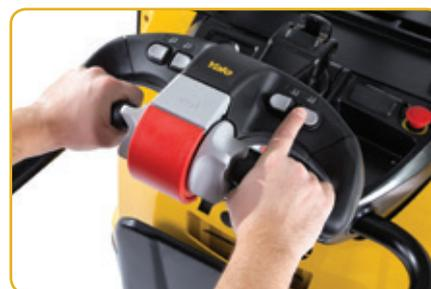
transferts sur des sols irréguliers, des niveaux de chargement et des rampes. Deux boutons-poussoirs placés sur la gauche du timon commandent la levée et la descente. Les tirants réglables donnent un mouvement de levage et descente uniforme des fourches. Les doubles galets de charge sont dotés de points de graissage et de roulements étanches. La vitesse est automatiquement réduite lorsque les bras porteurs sont levés.
