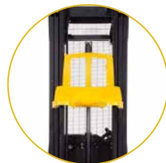
Ampia finestra del montante per una movimentazione più produttiva dei carichi, minor affaticamento e stress per l'operatore
