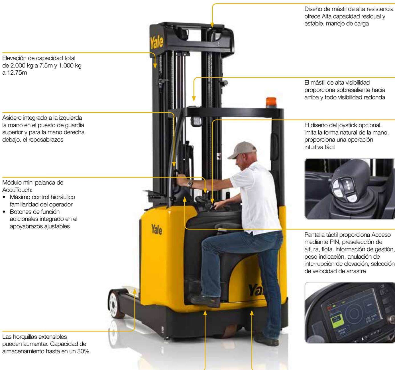
Elevación de capacidad total de 2.000 kg a 7.5m y 1.000 kg a 12.75m
