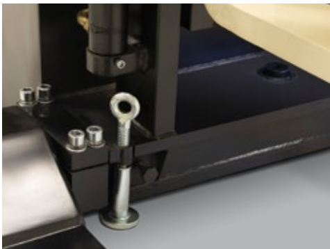
Las patas estabilizadoras son ajustables
