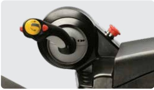
**DIRECCIÓN ELÉCTRICA** - La dirección eléctrica totalmente ajustable (de tope a tope) permite al operador personalizar el esfuerzo de dirección para adaptarse a las preferencias personales y a las necesidades de la aplicación. Esta característica puede ayudar a aumentar la confianza y a reducir la fatiga de los operadores al maniobrar en áreas estrechas y congestionadas.
