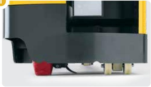
**CHASIS DE CUATRO PUNTOS** - La rueda motriz, la rueda giratoria doble de caster las dos ruedas de carga<sup>3</sup> crean una posición de cuatro puntos para ayudar a mejorar la distribución del peso de la carga y maximizar la estabilidad de la carretilla elevadora.
