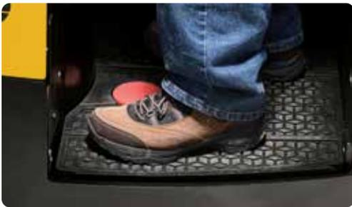
**PLATAFORMA DEL OPERADOR** - El sistema de piso suspendido se ha diseñado para que descansa sobre cuatro (4) aislantes de goma atornillados al bastidor de accionamiento para ayudar a reducir los golpes y las vibraciones que se transmiten a los pies, la espalda y las piernas del operador de las placas del muelle de embarques, las juntas de los pisos y otras superficies irregulares del suelo.
