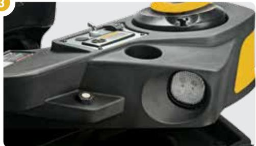
**LUCES DE TRABAJO LED CON SENSOR + ULTRASÓNICO** Ayude a aumentar la visibilidad y el percepción en áreas poco iluminadas, como los remolques de transporte, con las luces de trabajo LED automáticas opcionales<sup>4</sup>
