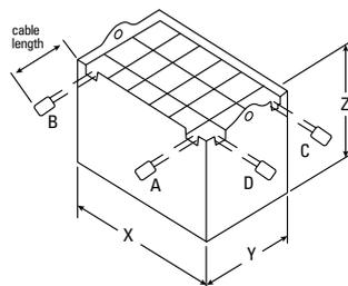
La longitud del compartimiento de la batería se mide de parte delantera a parte trasera.
